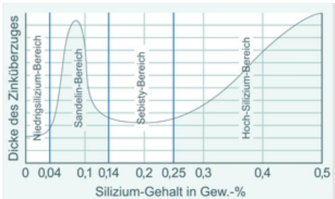
Diagramm 2 – Abhängigkeit der Auftragsmasse vom Siliziumanteil im Stahl – Sandelin Kurve
